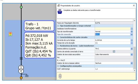
pontos de conexão (usuário), cada um com um dos três lados do transformador. Os dados elétricos seguem o modelo relatado na norma CEI EN 60909, que se refere às potências laterais, ou seja, as de cada par de enrolamentos. Na bibliografia, entretanto, os valores de potência dos enrolamentos individuais, chamados H, M, L, são frequentemente encontrados como dados de placa.
