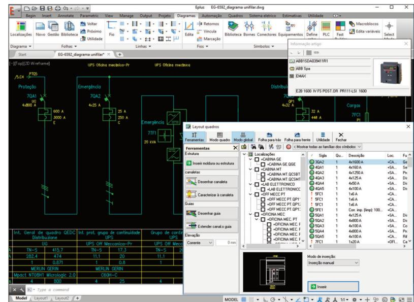
das, coletores, cabos e respectiva disposição em planta, com criação do modelo de dados para o Ampere. Conexão bidirecional com Ampere para o cálculo da rede.
